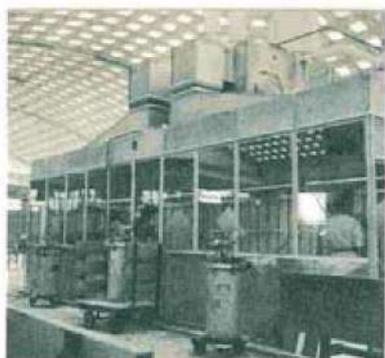
2- Une des cabines où s'effectue le pistolage de l'émail avant la cuisson au four-tunnel qui permet d'émailler 1 600 kg de tôle fine à l'heure.
